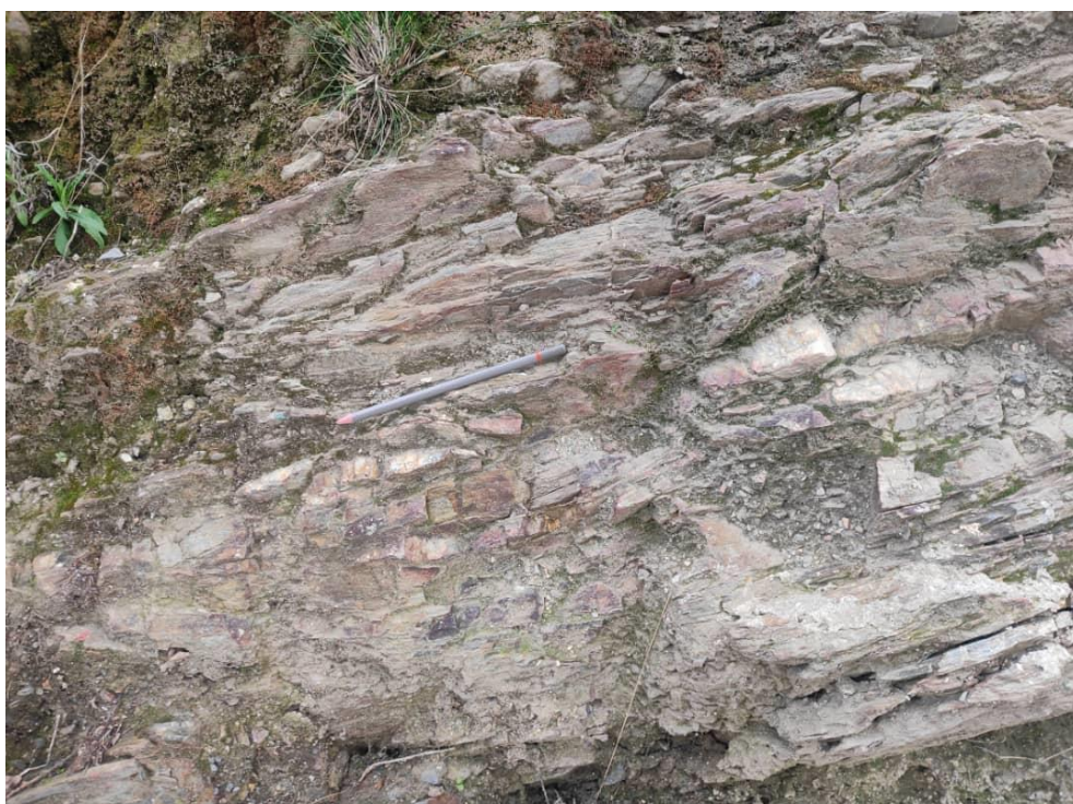
Figure 60 : photo montrant Altération Eboulis- Marnes-Argiles rouges (route évitement Azazga) Source : DUC Tizi Ouzou
