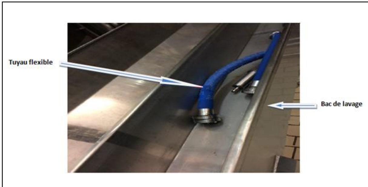
Figure I.9 : Nettoyage des tuyaux flexibles.
