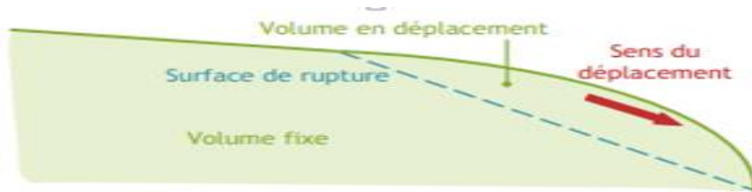
Figure n°1.17: Schéma explicatif du glissement plan. Source: www.brgm.fr .
