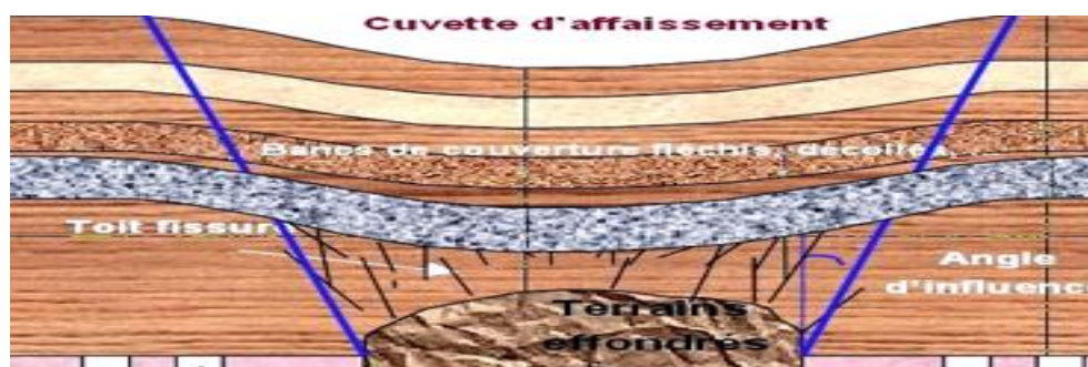
Figure n°1.9 : Schéma affaissement progressif. Source : www.brgm.fr .
