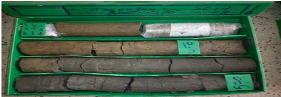
Figure n°3.11 : Contact entre les marnes altérées et les marnes saines.
