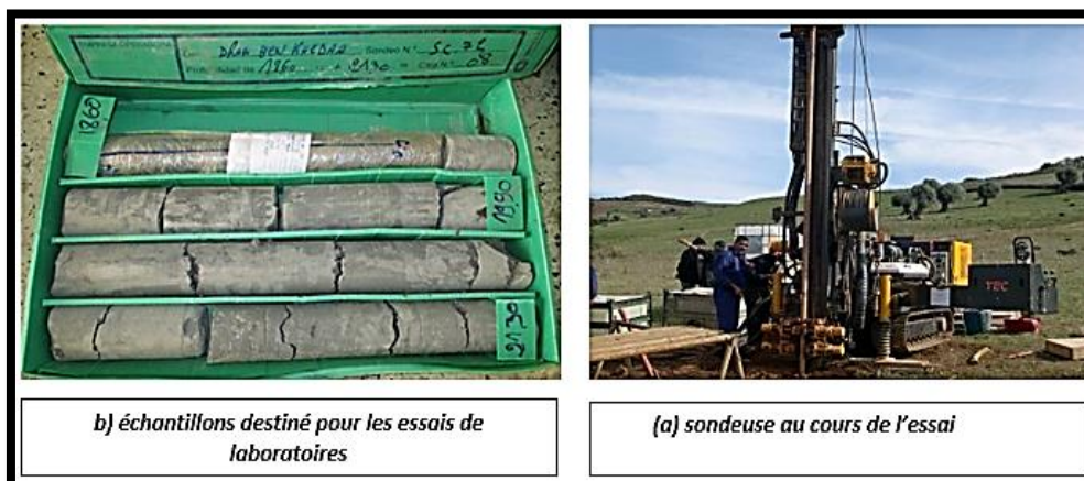
Figure n° 3.9 : Sondage au point d'essais SC-74.
