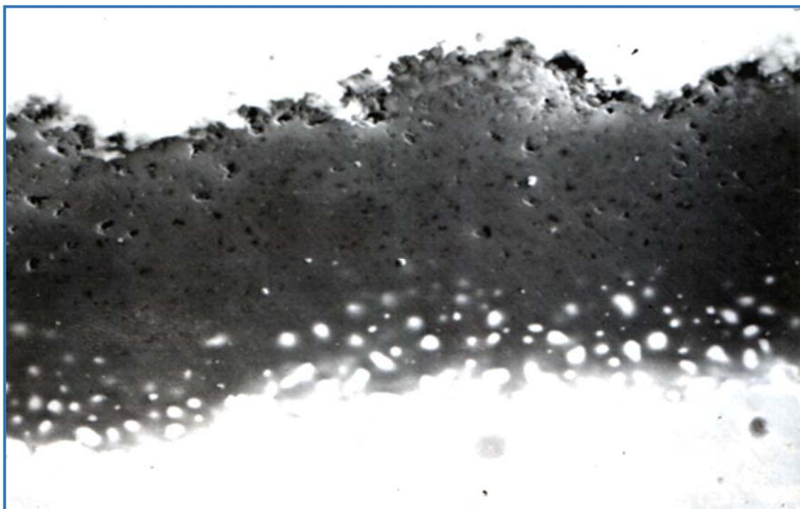
Figure 5.8. Couche d'oxyde (T=1350C°)
