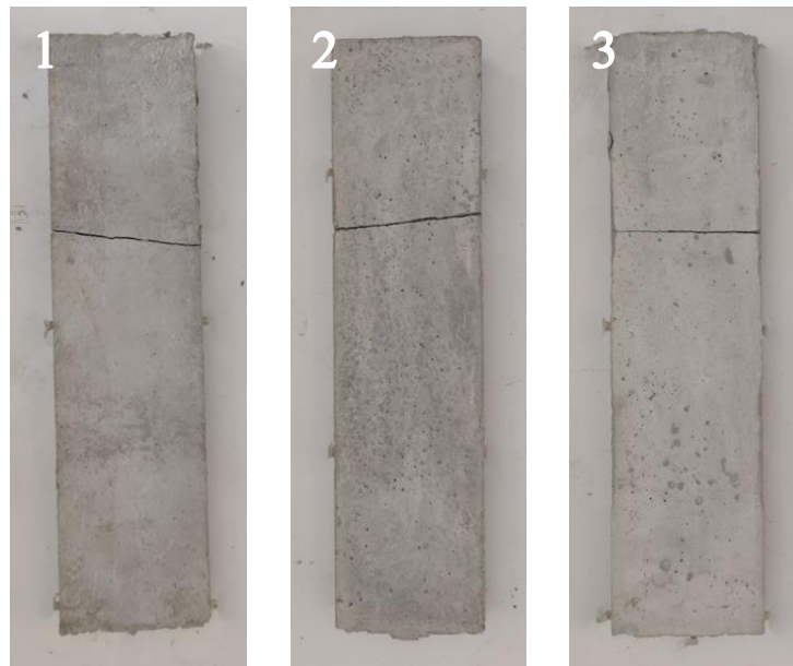
Figure V.43 : Modes de ruptures des plaques avec renfort et 1.5%PP après cycles HR : 1) sable de rivière, 2) sable de Touggourt et 3) sable de Bou Saâda.
