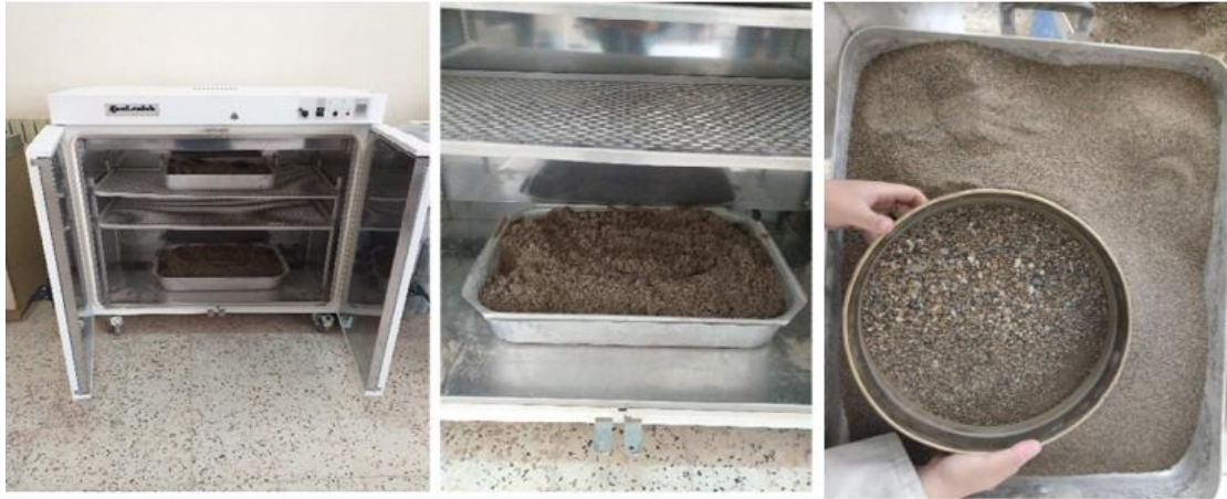
Figure IV.6 : Sable de rivière tamisé après avoir été lavé et séché à l'étuve au niveau du laboratoire béton-UMMTO.
