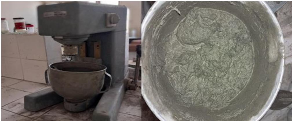
Figure IV.17 : Malaxeur électrique utilisé dans le malaxage au niveau du laboratoire béton-UMMTO.
