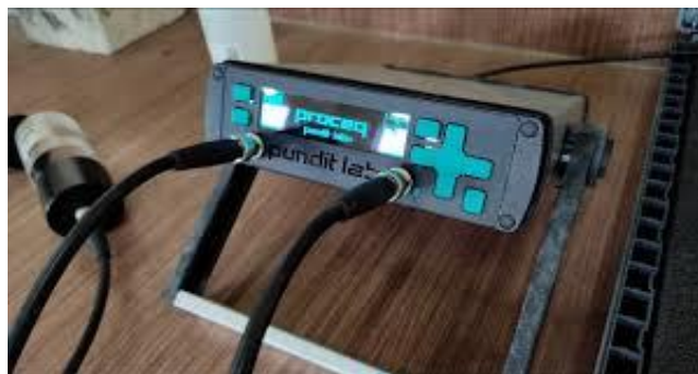
Figure IV.23 : Appareil PUNDIT pour mesure de la vitesse de propagation des ondes.
