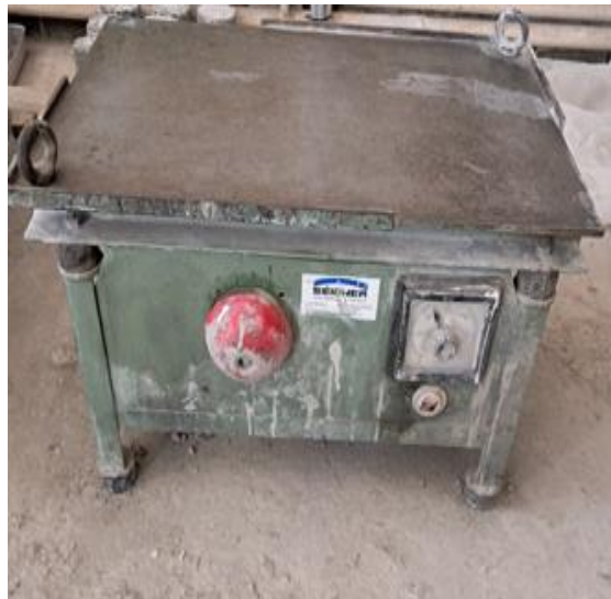
Figure IV.20 : Les éprouvettes sont vibrées sur une table vibrante.
