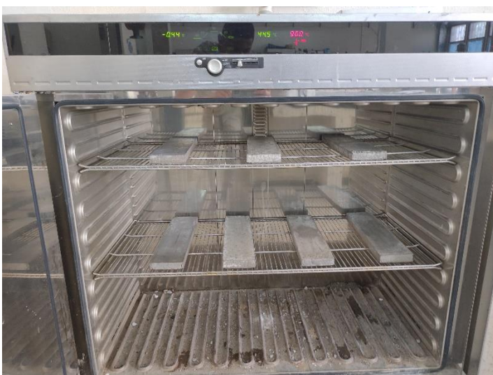
Figure IV.29 : éprouvettes en cours de traitement thermique dans l'étuve.
