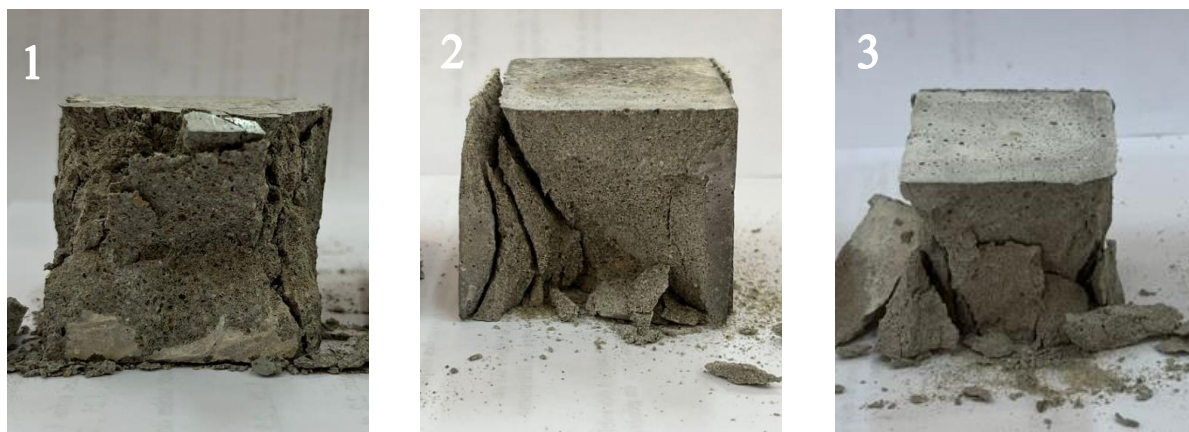
Figure V.17 : Modes de ruptures des éprouvettes cubiques avec 1,5%PP exposées aux cycles chaleur- pluie : 1) sable de rivière, 2) sable de Touggourt et 3) sable de Bou Saâda.
