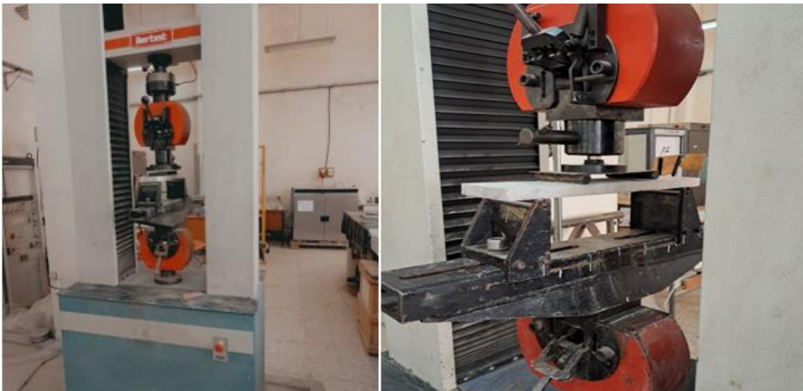
Figure IV.26 : L'essai de flexion quatre points avec la machine IBERTEST au niveau du laboratoire de béton [UMMTO].
