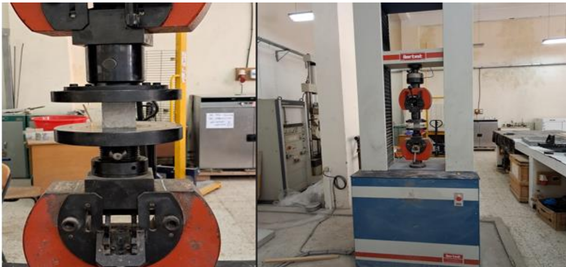
Figure IV.24 : Les essais de compressions avec la machine IBERTEST niveau du laboratoire de béton [UMMTO].
