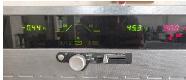
Figure IV.27 : Réglages de l'étuve Memmert pour le traitement thermique des éprouvettes.
