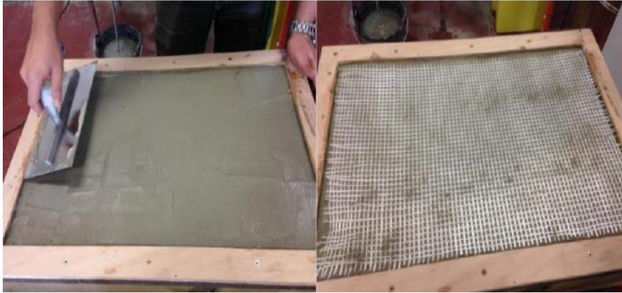
Figure II.7 : Technique de moulage au contact [7].
