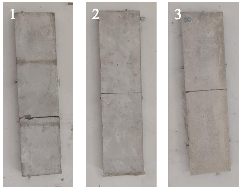
Figure V.40 : Modes de ruptures des plaques avec renfort après cycles HR : 1) sable de rivière, 2) sable de Touggourt et 3) sable de Bou Saâda.
