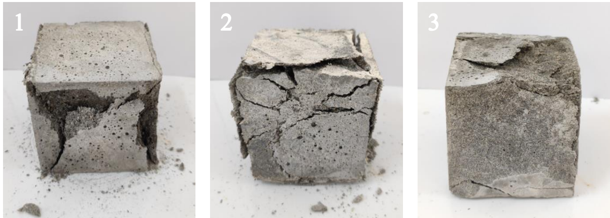
Figure V.10 : Modes de ruptures des éprouvettes cubiques avec 1.5%PP : 1) sable de rivière, 2) sable de Touggourt et 3) sable de Bou Saâda.
