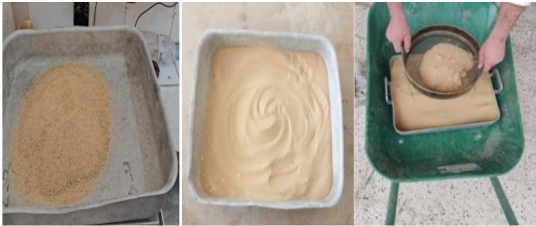
Figure IV.7 : Sable de dune tamisé après avoir été lavé et séché à l'étuve.
