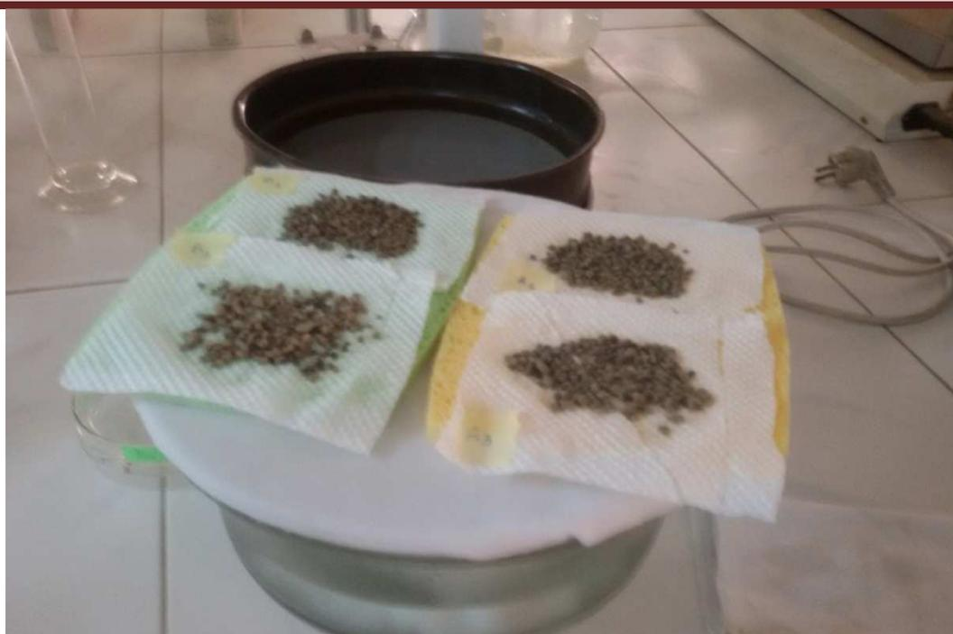
**Figure 18 : Test d'humectation par capillarité**
