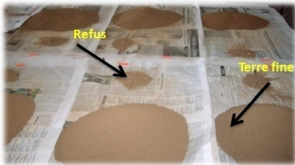
**Figure 14 : Tamisage des échantillons au tamis de 2mm.**
