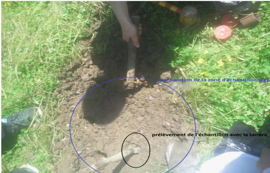
Figure 6: Photo illustrant le prélèvement des échantillons
