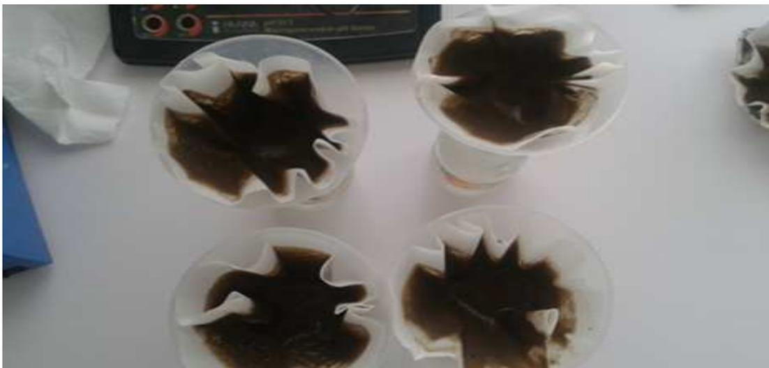
Figure 2 : Photo illustrant la détermination de la matière sèche
