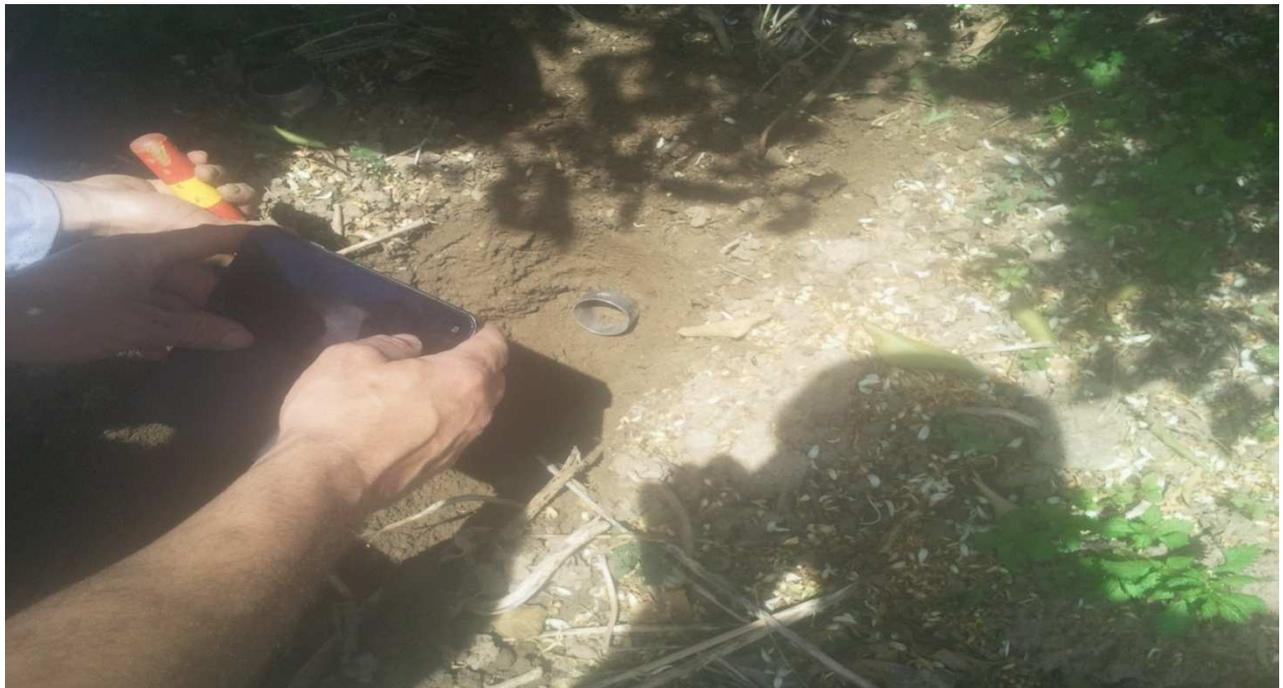
Figure 15 : Prélèvement du sol par la méthode au cylindre
