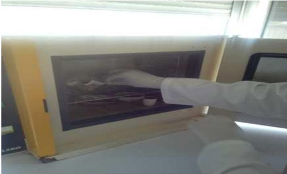
**Figure 4: Photo illustrant la détermination des matières volatiles sèches**
