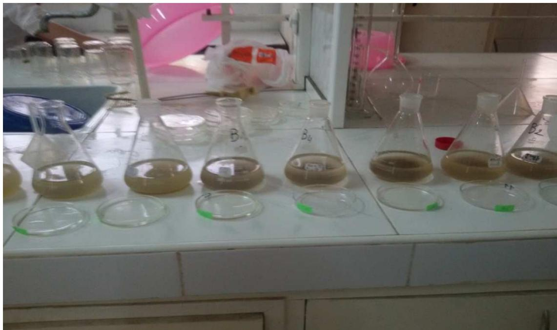
**Figure 19 : Désagrégation mécanique par agitation après réhumectation**
