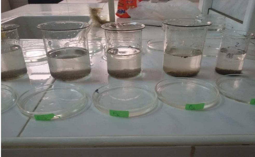
**Figure 17 : Le test d'humectation à l'eau**
