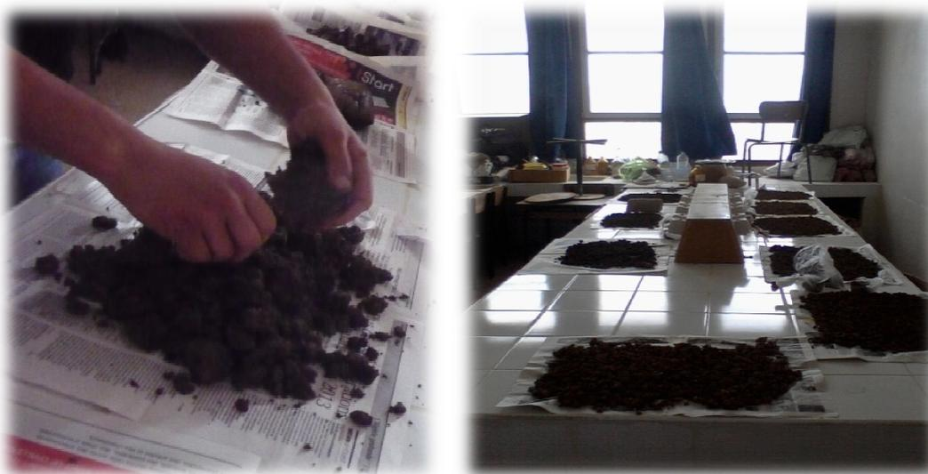
Figure 13 : Sechage des echantillons a l'air libre au laboratoire
