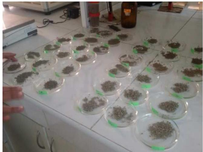
**Figure 16 : Tamisage et pesage des sols à 2 et 5mm**
