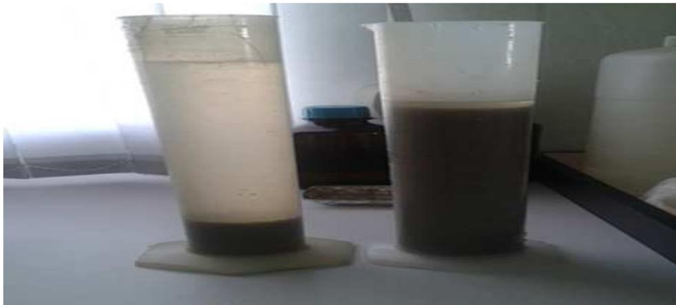
**Figure 3: Photo illustrant le test de décantation V<sub>30</sub>**
