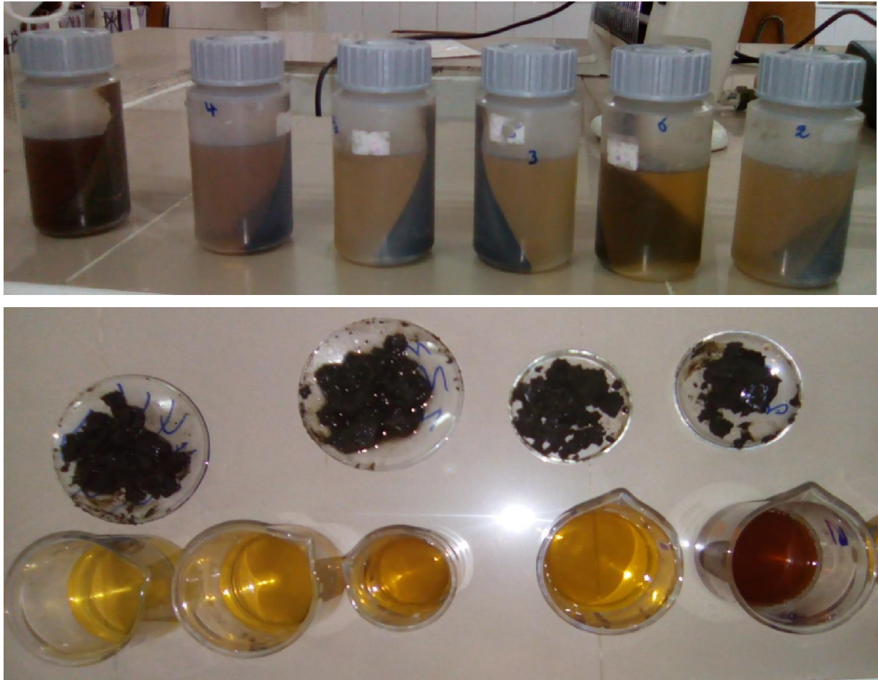
Figure 13. Extraction des acides humiques et fulviques
