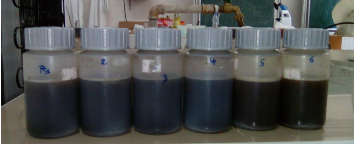
Figure 8 : Extraction des acides humique et fulvique
