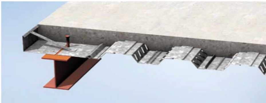
Figure 3.1 : Poutre de rive dans une construction mixte.
