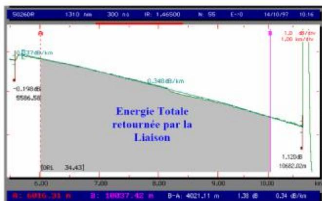
Figure V.15. Réponse impulsionnelle du réflectomètre.
