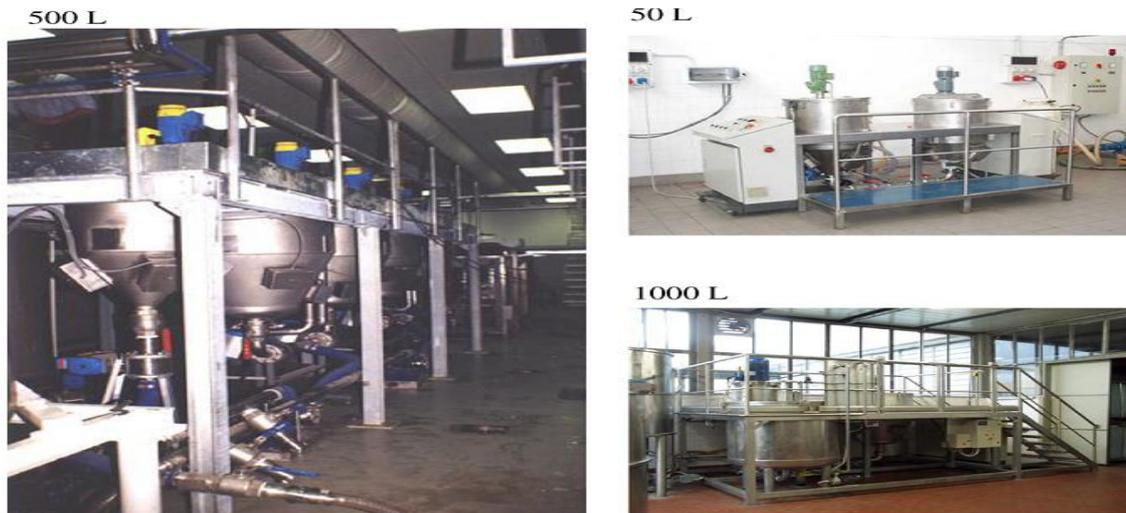
**Figure 5 :** Equipements ultrasoniques industriels : 50, 500 and 1000 l (Chemat et *al.*, 2011)
