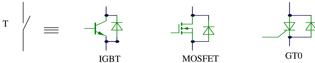
Figure (2.5) : Interrupteurs de puissance
