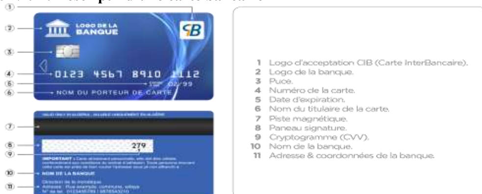
Figure N°01 : Descriptif d'une carte bancaire
