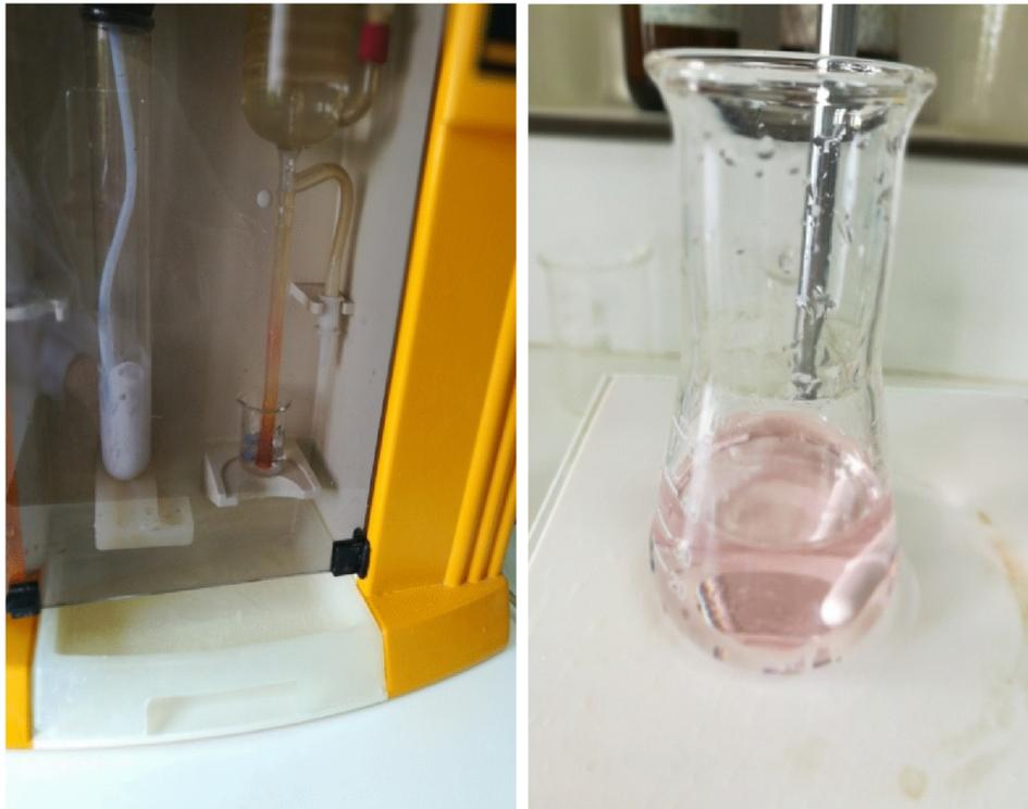
**Figure 25 : Appareil du minéralisateur Figure 26: Etape de la distillation**
