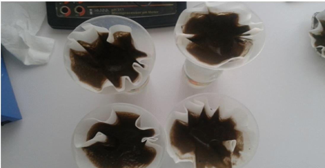
**Figure 08: Photo illustrant la filtration de la matière sèche.**
