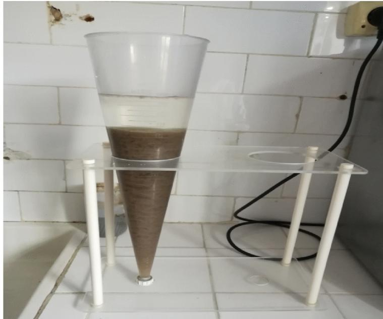
**Figure 09: Photo illustrant la décantation V30**
