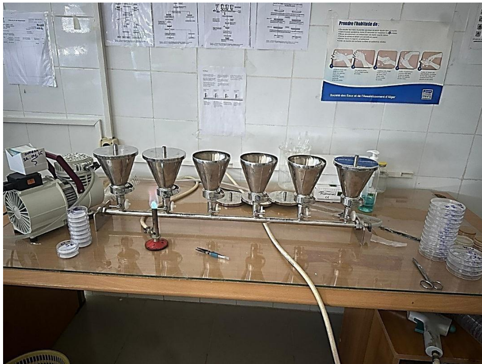
Figure 6 : Méthode par filtration (Photo original SEAAL, 2025)
