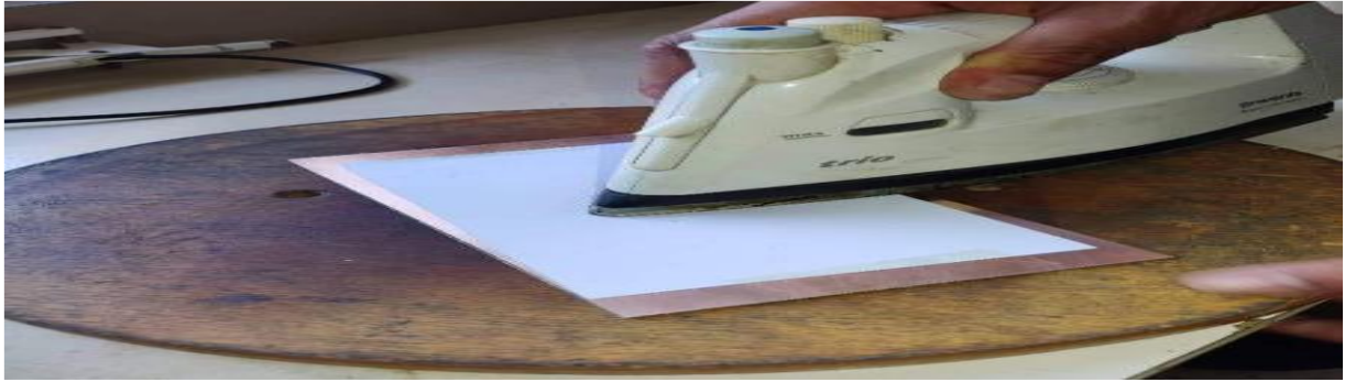
Figure 59: transfert du circuit à l'aide d'un fer à repasser
