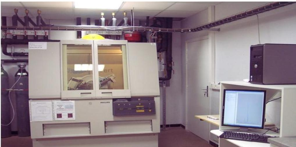
Figure 13 : Diffractomètre de poudres (Philips PWO4 XPert pro x-ray).
