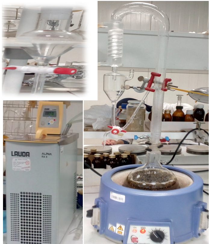
Figure 18 : Montage d'extraction par le Clevenger (hydrodistillateur standardisé) et de l'ampoule à décanter.
