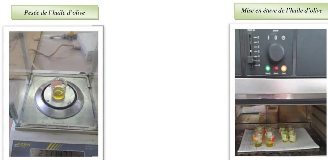
**Figure 27** : Détermination du taux d'humidité dans les huiles récoltées (Original).
