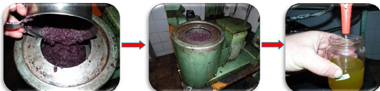
**Figure 25** : Extraction de l'huile d'olive par un oléodoseur (Original).
