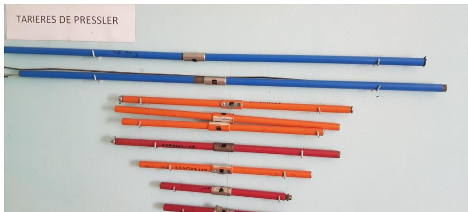
Figure 13 : tarières de pressler.
