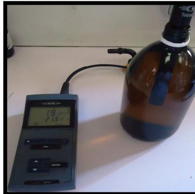
Figure n°26 : conductimètre WTW modèle 3110.
