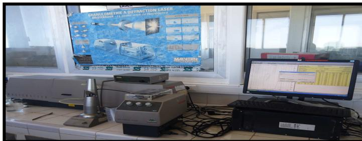
**Figure n°28:** granulomètre laser.
