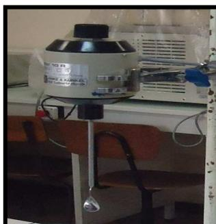
**Figure n°22 :** agitateur mécanique.
