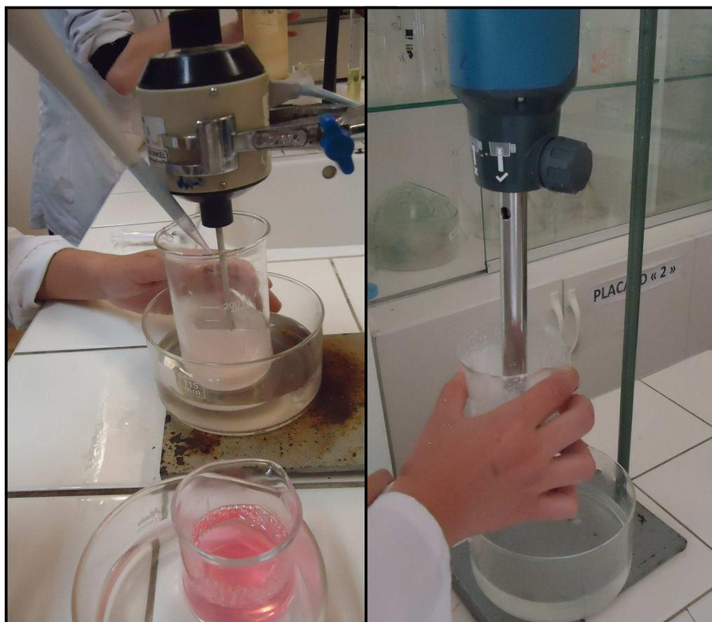
**Figure n°30 :** étapes de préparation des émulsions (à gauche : introduction de la phase hydrophile dans la phase lipophile sous agitation, à droite : homogénéisation).
