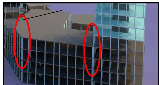
Figure 133: les joints de ruptures dans notre projet.
