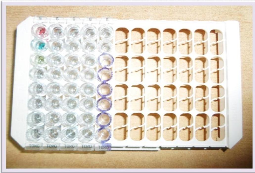
**Fig.26:** Les échantillons dilués dans des puits de la microplaque (Originale, 2015).
