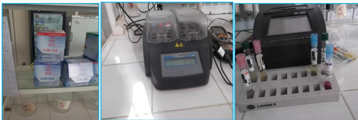
Figure 18 : Matériels utilisés pour déterminer la DCO.
