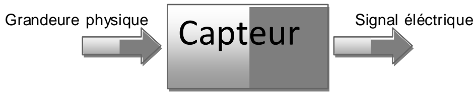
Figure I.2 : Principe des capteurs.
