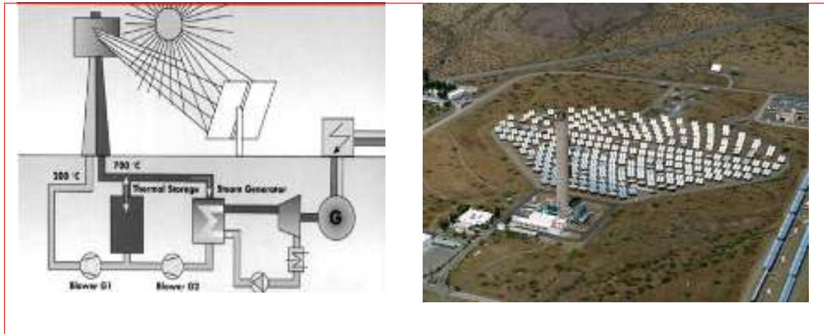
Figure III.12 : La figure à droite représente la CESA ONE en image réelle, la figure à gauche décrit son mode de fonctionnement.
