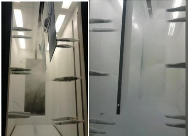
**Figure V.6 : La pulvérisation électrostatique**
