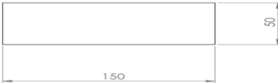
**Figure IV.11: Dimension des éprouvettes de pliage selon la norme NF A 03-158**
