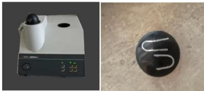
Figure IV.16 : Enrobeuse utilisée
