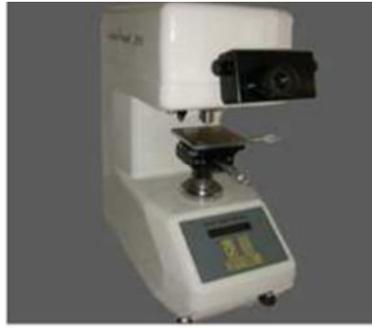
**Figure. IV.19 : Micro Duromètre**
