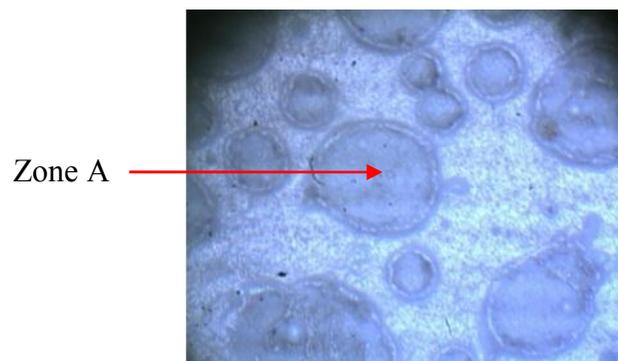
Figure V.18 : Résultat de l'attaque corrosive
