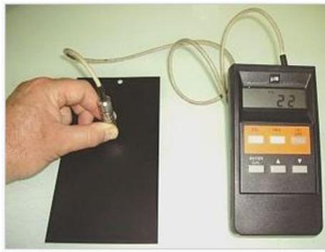
Figure III.4 : Appareil portable à induction magnétique.
