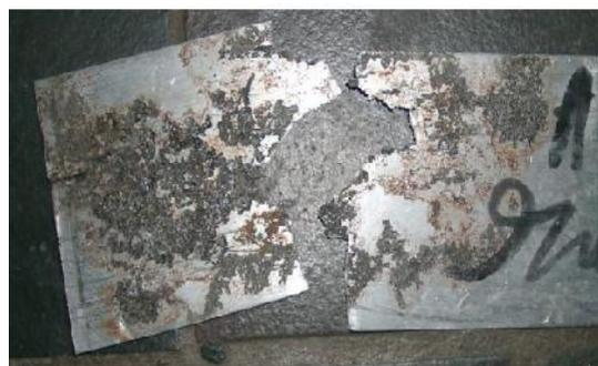
Fig. II.3- : Exemple de Corrosion par Piqûres
