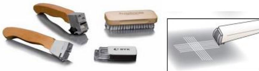
Figure III.6: Outils utilisé pour essai de quadrillage
