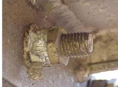
Fig. II.2: Exemple de corrosion galvanique
