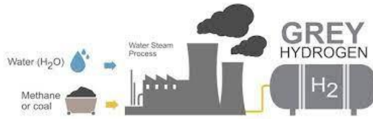
Figure 2.2 : processus de production de l'hydrogène gris.
