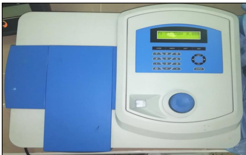
Figure N° 23 : Spectrophotomètre utilisé pour l'absorption des souches bactériennes.
