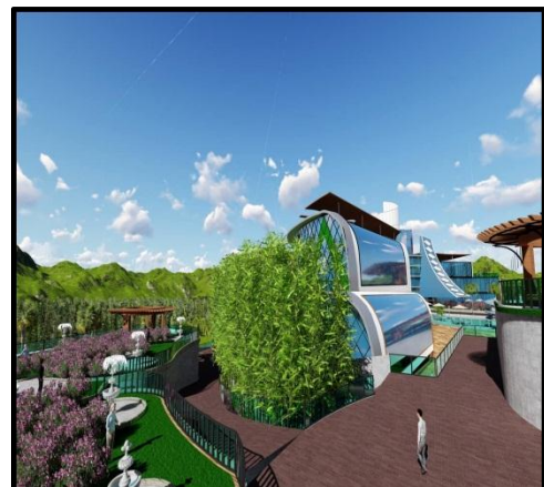
Figure 160: la réorientation des vents par la forme arrondi ; Source : Elaboré par l'auteur
