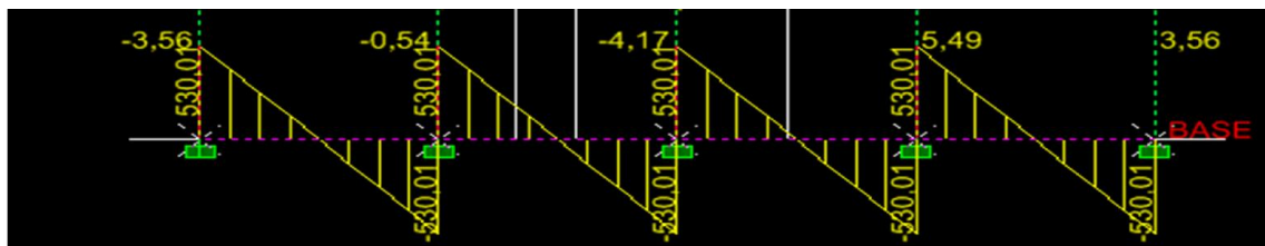
Figure: VI-4-a-2 : Diagramme des efforts tranchants à l'ELU (KN).
