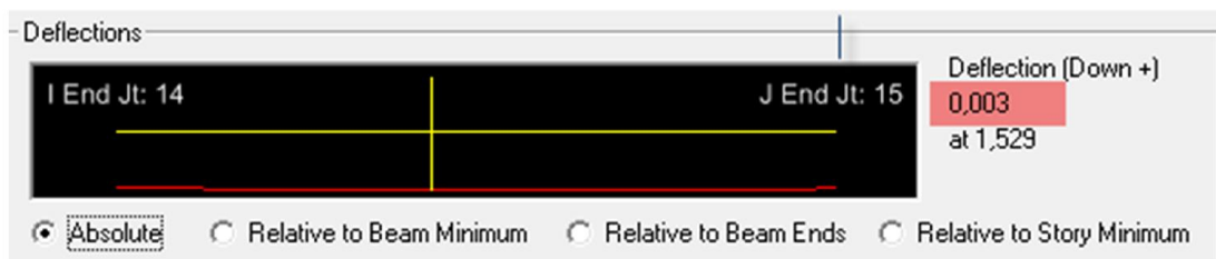
Figure V-1-6 : vérification de la flèche sens y-y
