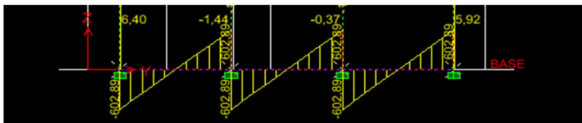
Figure : VI-5-a-2 Diagramme des efforts tranchants à l'ELU (KN).
