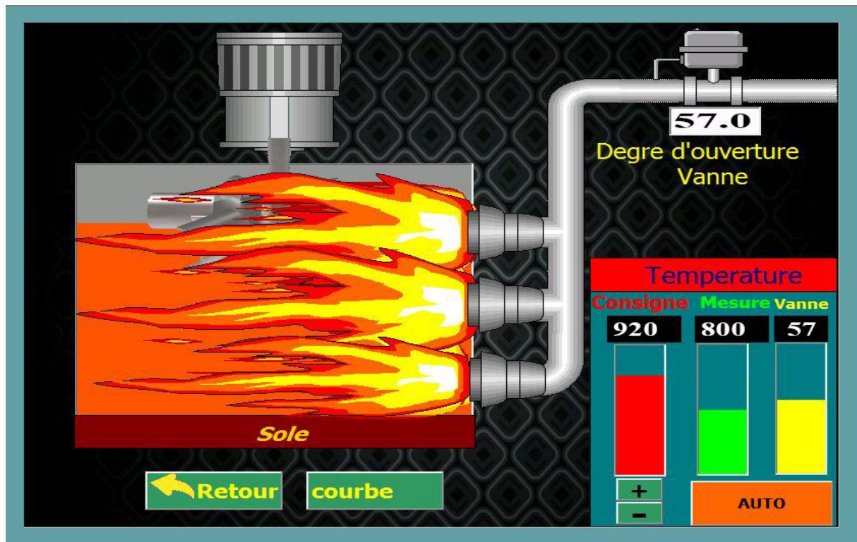
Figure V.22 : Simulation de la Chambre de chauffe.
