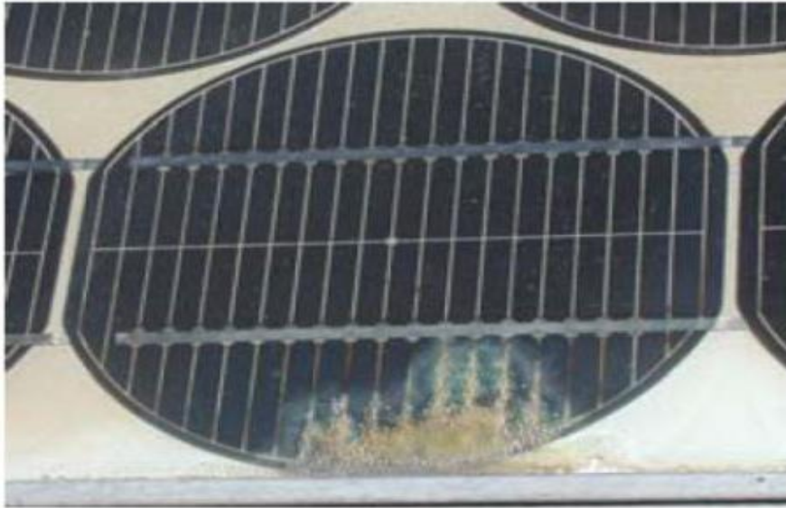
Figure III.18: Délaminage du module [7]
