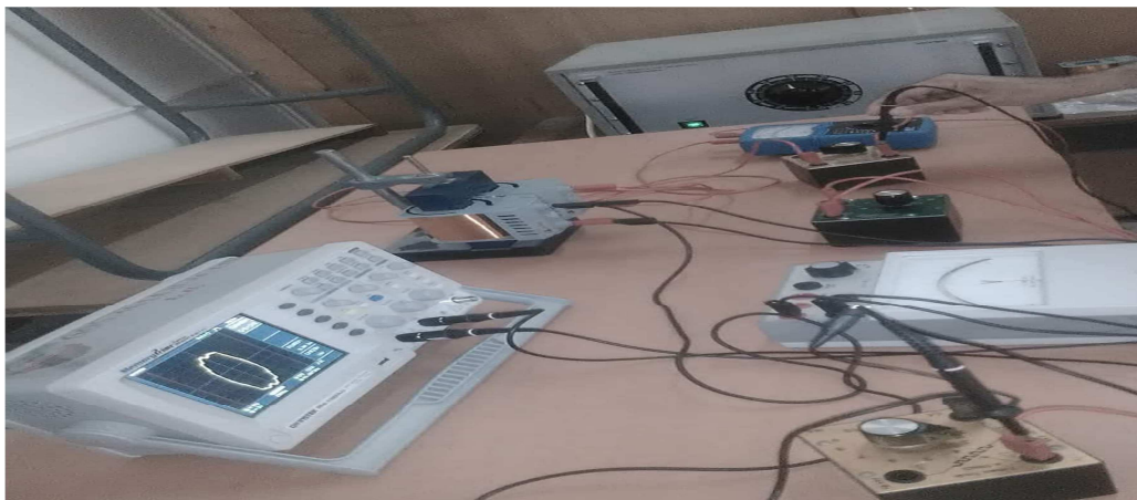
Figure III-1 : schéma de montage pour le relevé du cycle d'hystérésis
