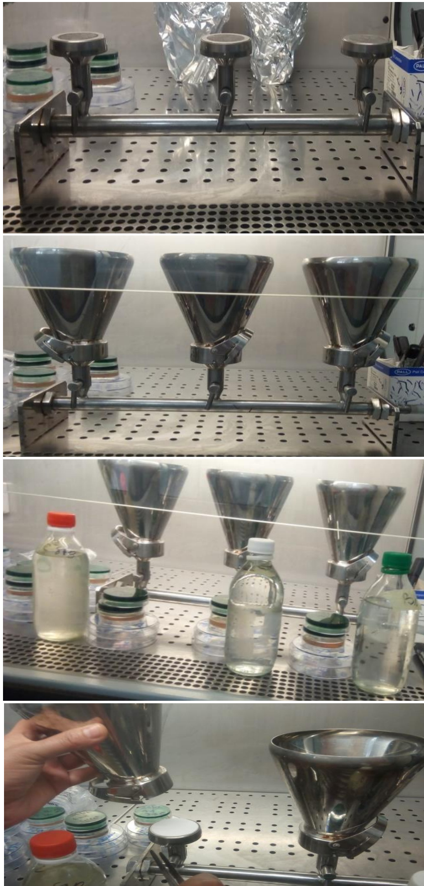
Figure 09 : illustrations du matériel utilisé pour le contrôle microbiologique de l'eau traité et les eaux de rinçage selon la SPA Royal.
