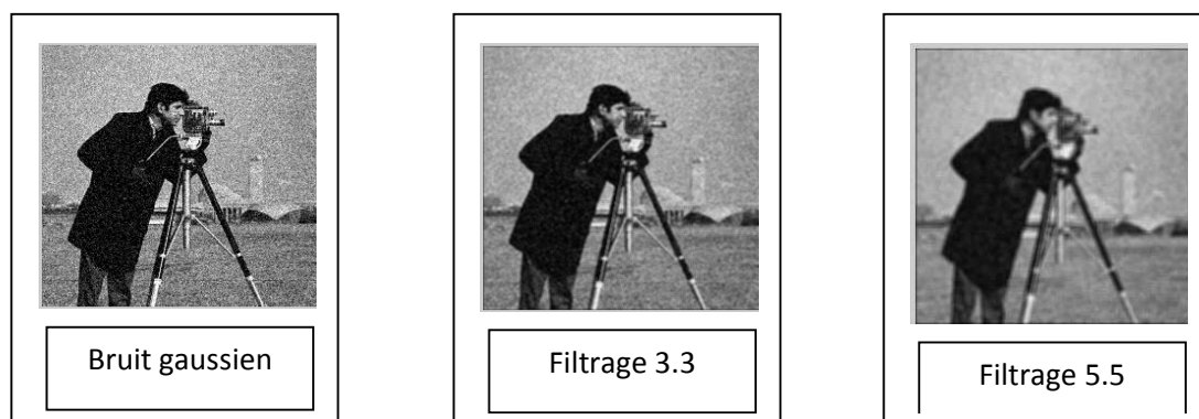
Figure I.3 : (a) Image d'origine affecté par un bruit gaussien, (b) l'image 'a' filtré par un filtre moyenneur de taille 3x3, (c) l'image 'a' filtré par un filtre moyenneur de taille 5x5.
