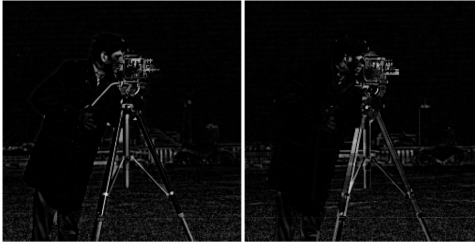
Fig.2.40: Chapeau haut de forme blanc (à gauche) et chapeau haut de forme noire (à droite) de l'image de la figure (2.31) avec un disque de taille 3.
