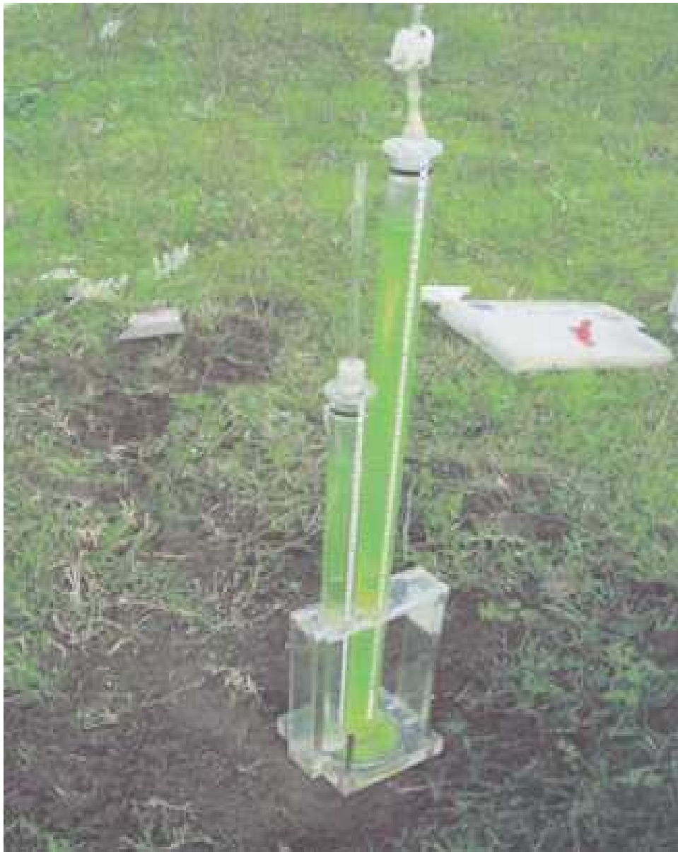
Fig.1.10:Infiltromètre à disque sur le terrain
