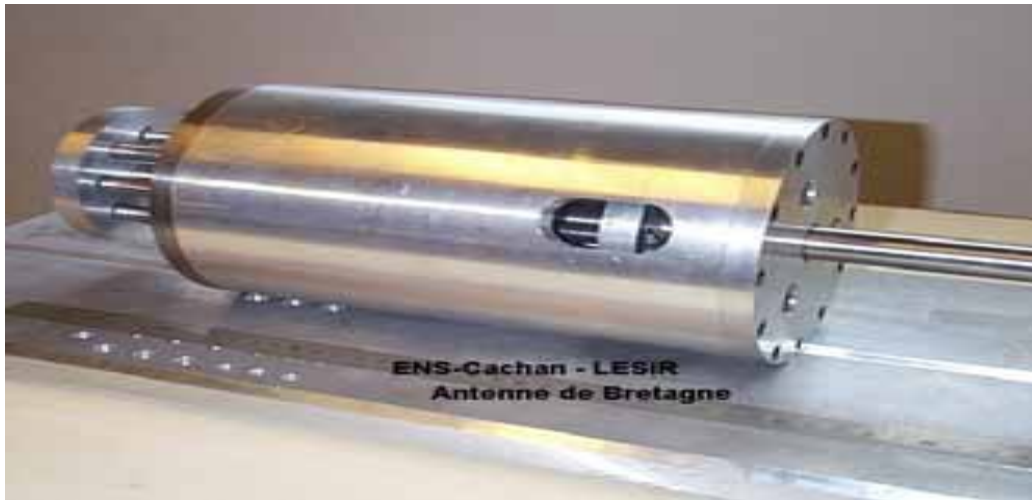
Figure I-3 : Structure tubulaire d'une machine linéaire.
