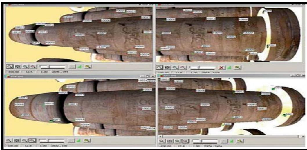
Figure 50 : Test d'aérotriangulation sur images de synthèse calculées sous POV-Ray
