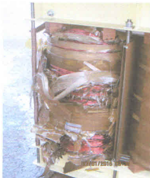
PHOTOS N°5 et N°6 : bobinage gonflé
