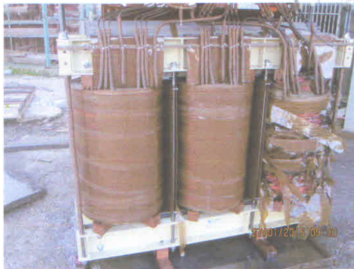
PHOTOS N°3 et N°4 : vue à l'intérieur du transformateur endommagé (Deuxième visite)
