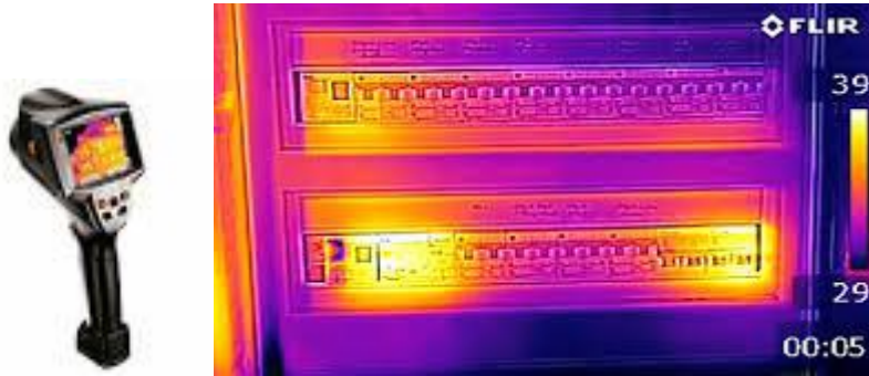
Fig III-9 : Photo d'une caméra thermique et d'une image produite
