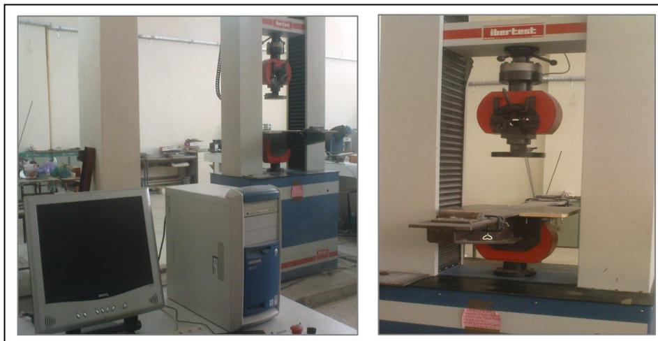
**Figure. II.10.** Machine de flexion IBERTEST
