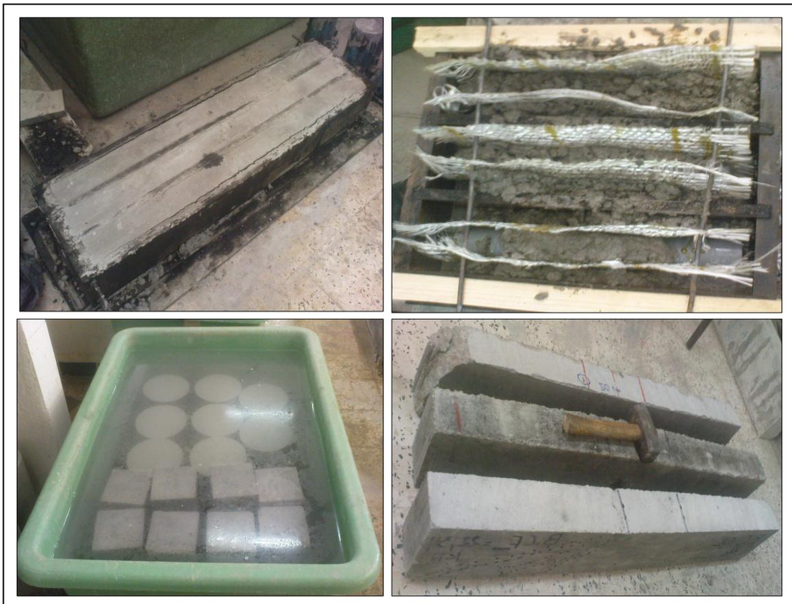
**Figure. II.9.** Bétonnage et conservation des spécimens avant murissement
