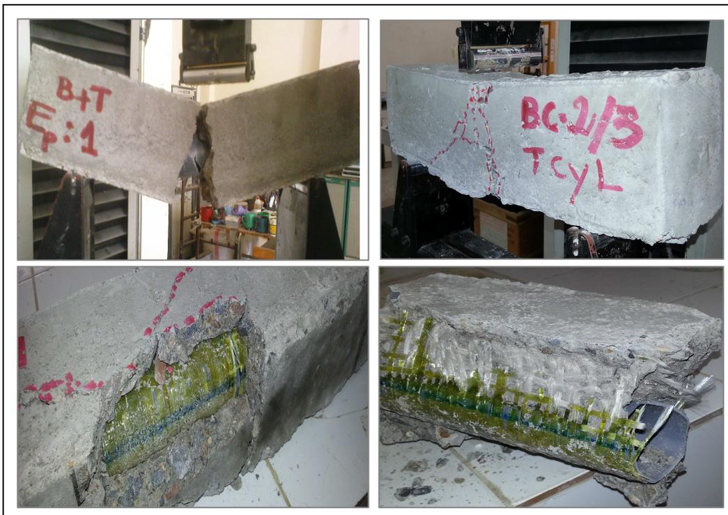
*Figure. II.12.* Comparaison des modes de rupture des spécimens prismatiques
