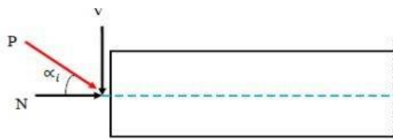
Figure VI.5 : Composantes de la force de la précontrainte
