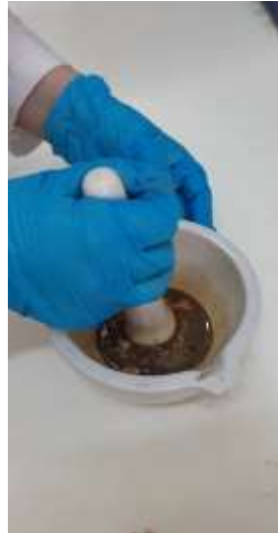
Figure n°18 : Homogénéisation des tissus de moules par broyage manuel (Photo originale, taille réelle)
