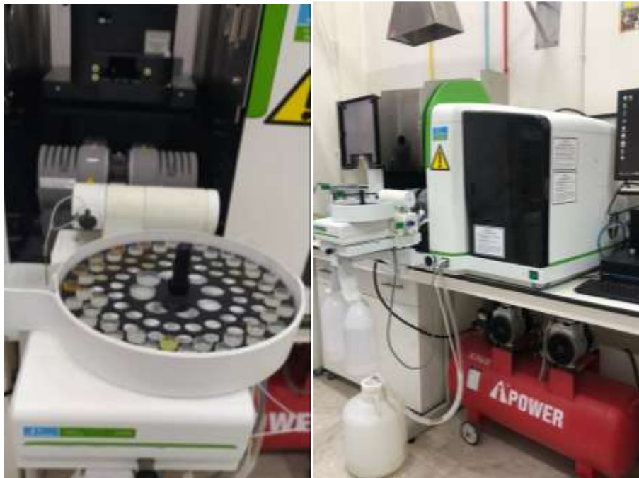
Figure n°15 : Spectromètre d'absorption atomique (SAA) PerkinElmer AS900 utilisé pour l'analyse des métaux traces (Photo originale, taille réelle)
