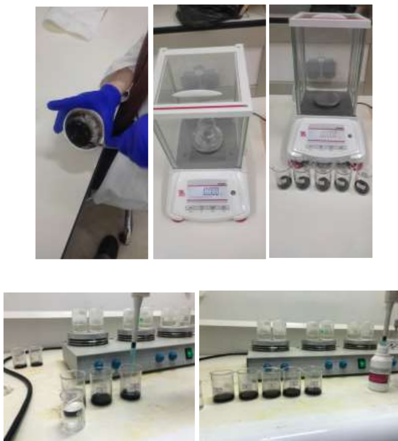
Figure n°21 : Préparation des extraits pour analyse par SAA : digestion acide (Photo originale, taille réelle)
