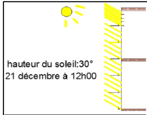
Figure 177: coupe schématique d'une façade sud en hiver.
