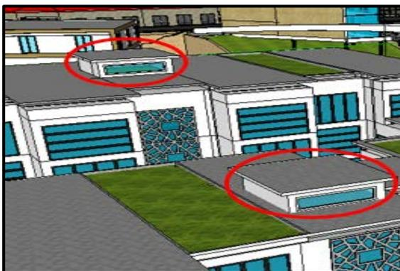
Figure 183 : Ouvertures en niveau des toitures (école de formation artisanale)
