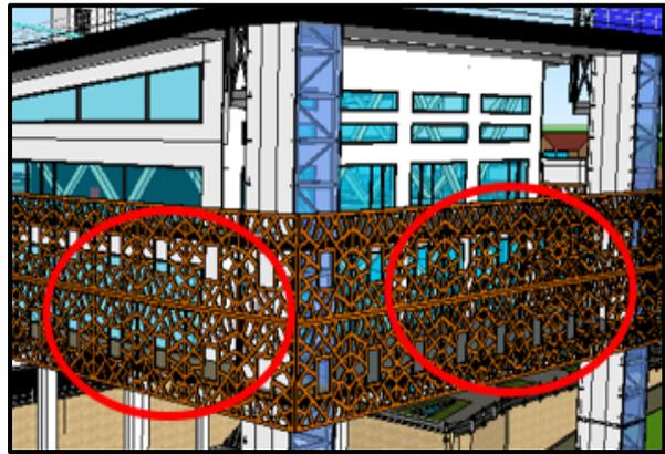
Figure 174 : Système des moucharabiehs (élément central).
