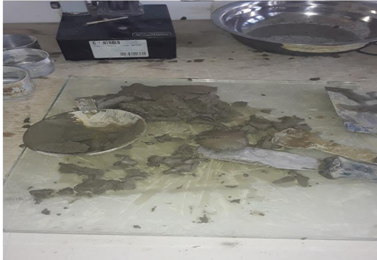
Figure IV.10 : Essai de limite de liquidité.
