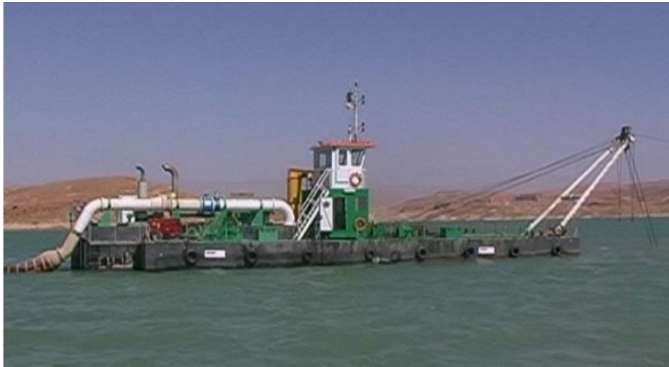
Figure II.3: Le dragage au centre de la retenue d'un barrage.
