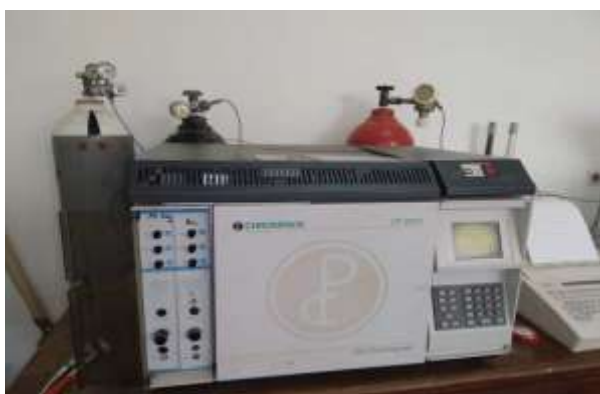
Figure 07 : Appareil de la CPG (Chrompack CP 9002)
