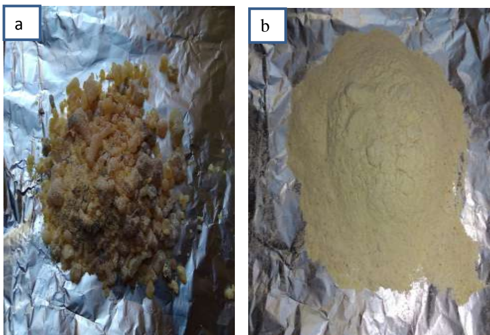
Figure 06 : Aspect de la résine de pin d'Alep a): sous forme de pierres ; b): sous forme de poudre
