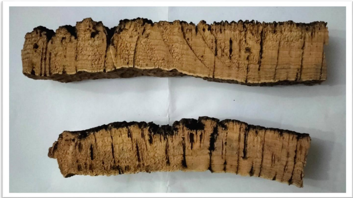
Figure 15 : Les éprouvettes utilisées pour les mesures de l'épaisseur sous croute du liège
