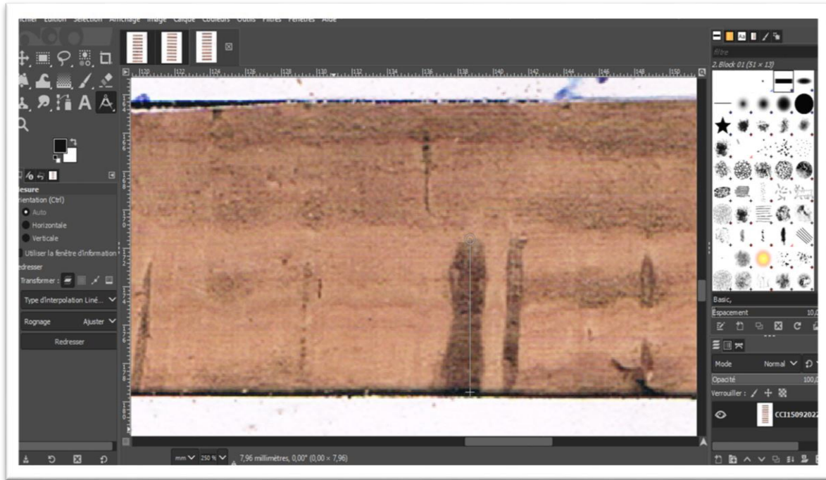
Figure 19 : La mesure de la longueur des lenticelles par le GIMP 2
