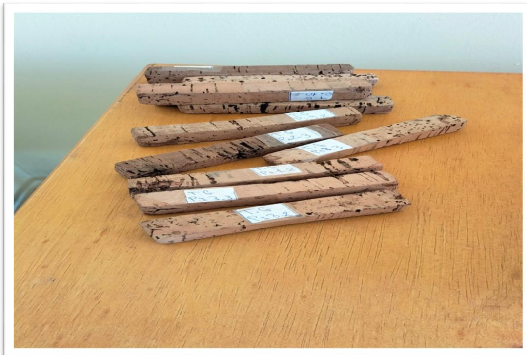
Figure 17 : Les éprouvettes utilisées pour la mesure de la porosité.
