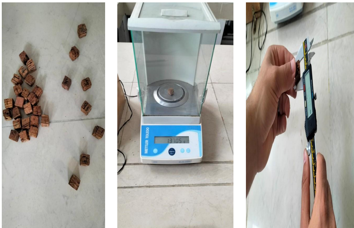
Figure 20 : Les éprouvettes utilisées pour les mesures de la densité et la balance de mesure de la masse des éprouvettes.
