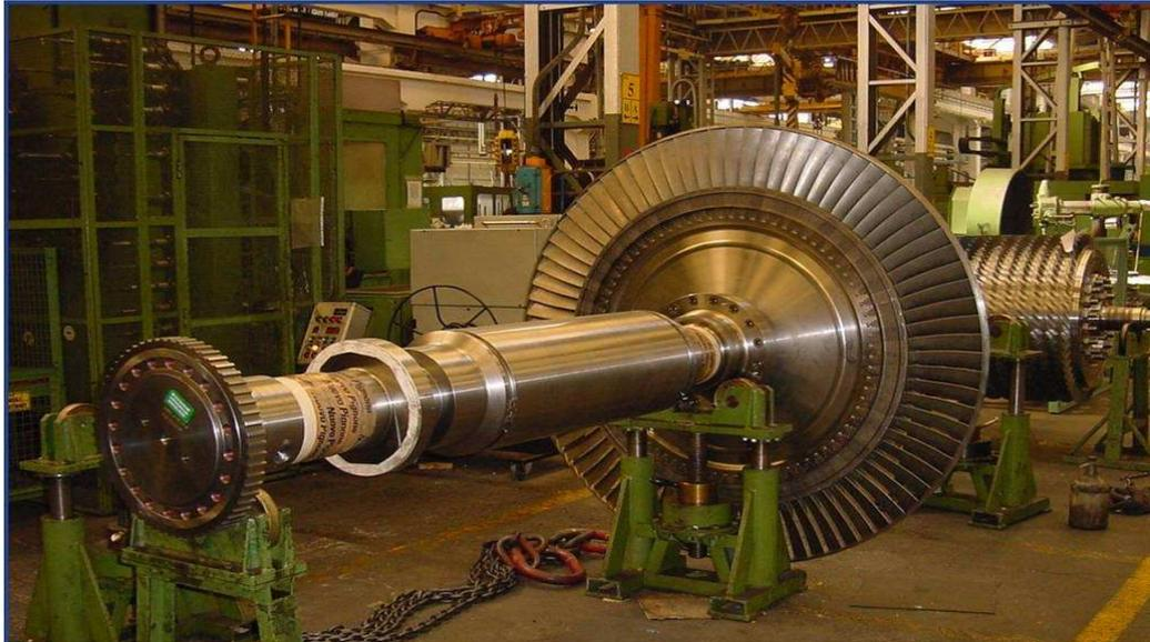
**Figure.III.10.** Rotor BP de la turbine à gaz MS5002C
