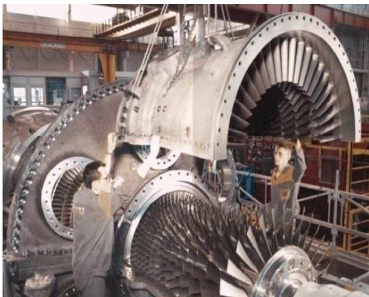
**Figure.III.3.** Stator du compresseur axial
