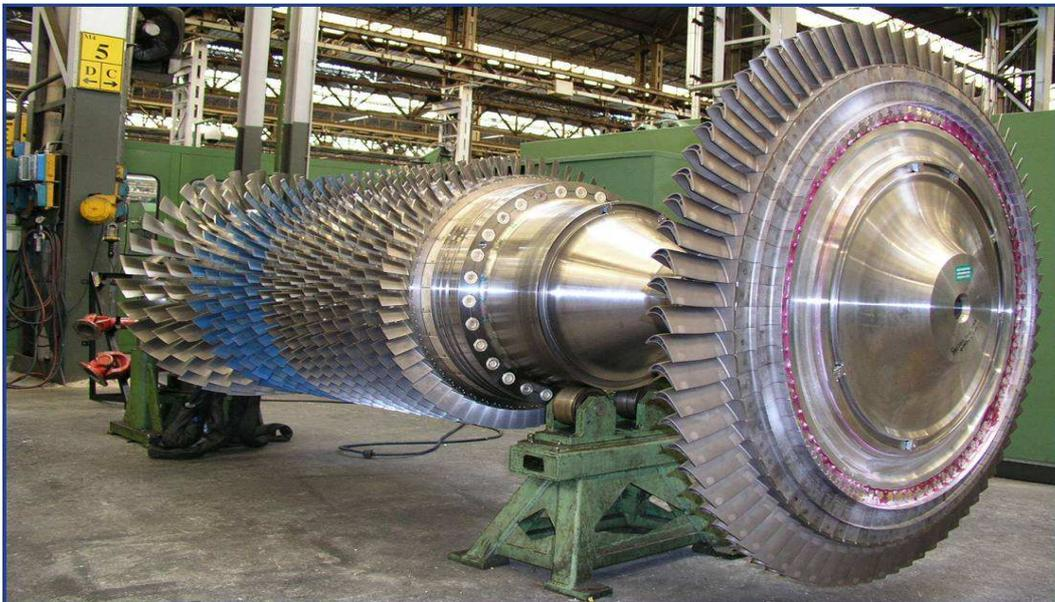
**Figure.III.9.** Rotor HP de la turbine à gaz MS5002C
