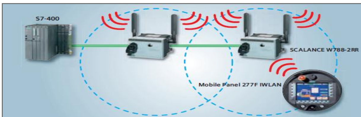
Figure 2.7 le passage d'une antenne à une autre, sans incidence sur les fonctions de sécurité gérées par le pupitre.
