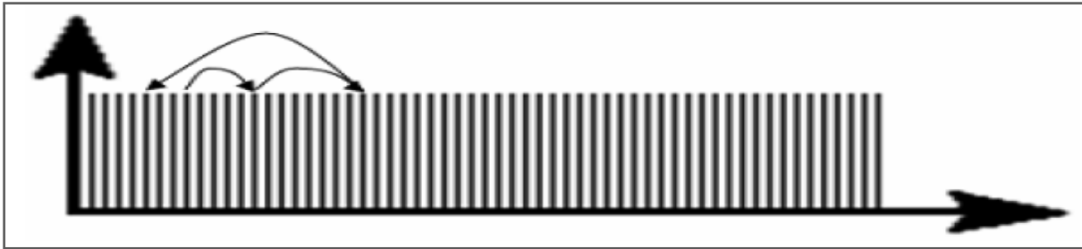
Figure 1.5 La technique d'étalement du spectre par saut de fréquence (FHSS)
