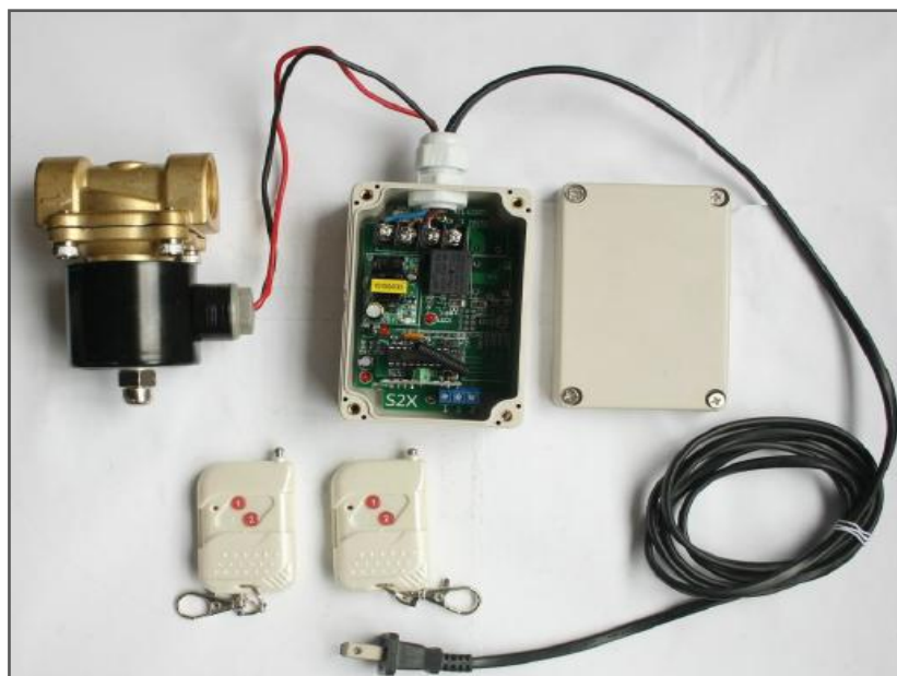
Figure 2.17 système de commande wifi d'une électrovanne
