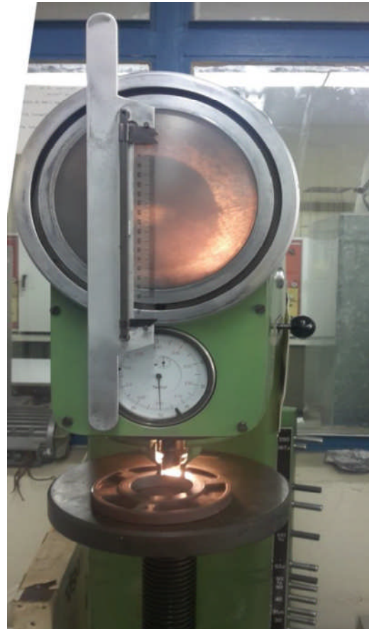
Figure 19 : Mesure de l'empreinte
