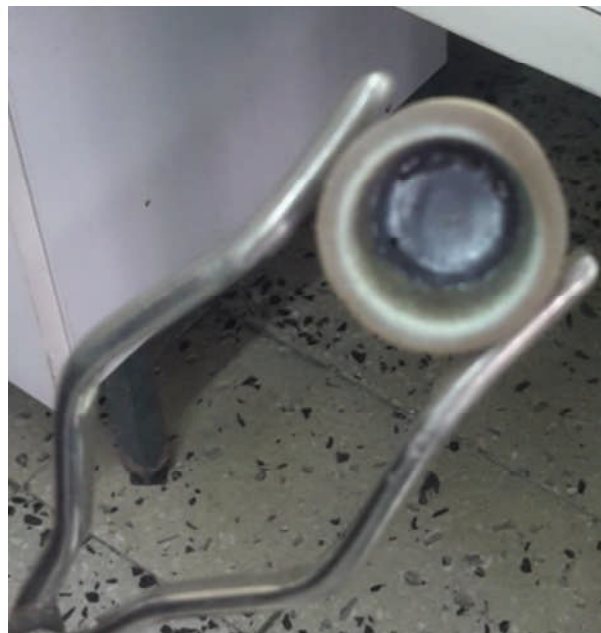
Figure 15 : Mélange de la fonte GG15 avec le Tungstène après combustion pour analyse.
